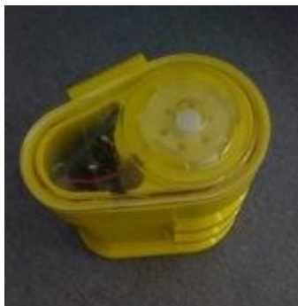
Figure 8 - Exemple d'un détecteur individuel actif mesurant l'EAPv (Source Algade)
