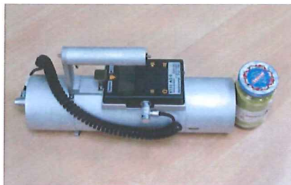
Figure 2 : Débitmètre Saphymo 6150 AD6.
