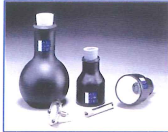
Figure 5 : Exemples de fioles scintillantes.
