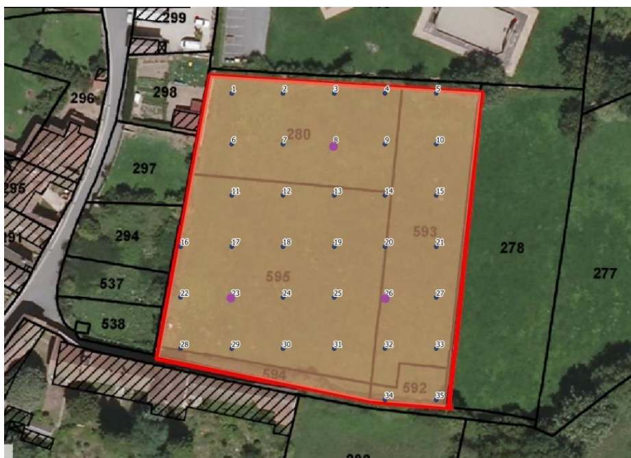
Figure 10 : Localisation des points de mesure (en violet) du flux surfacique d'exhalation du radon.
