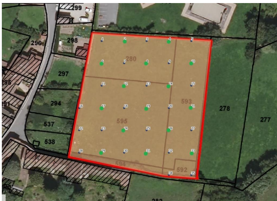
Figure 8 : Localisation des points de mesures (en vert) pour la cartographie de l'activité volumique du radon et de ses descendants.
